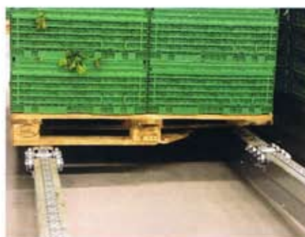
2 Mit Flow-Roll lassen sich auch stark beschädigte Euro-, Industrie-, Kunststoff- und Sonderpaletten fördern
