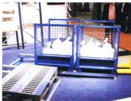
3 Flow-Roll ist sogar für den Transport von Gitterboxen oder anderen speziellen Lagergütern geeignet
