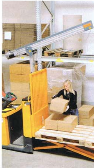
EcoPick® erleichtert das manuelle Heben beim Kommissionieren – bis zu 90 % des Gewichts werden vom Seilzug übernommen (Bild: Gebhardt)
